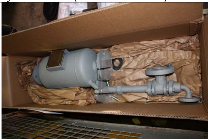
Körting Dampfstrahlsauger und Schalldämpfer (Saugluftbremse)
