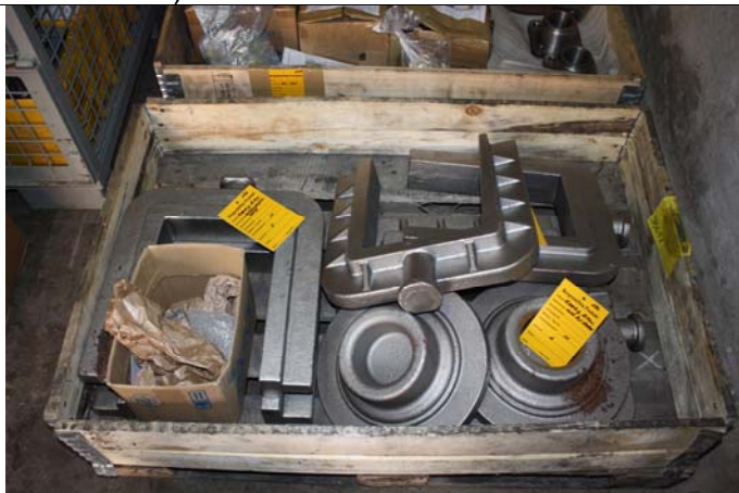
Gussteile: Achslagerführungen und Zylinderdeckel (Olbersdorfer Guss)
