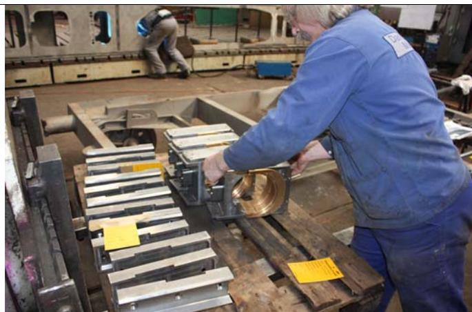
Achslagerführungen und Achslagergehäuse einbaufertig angeliefert
