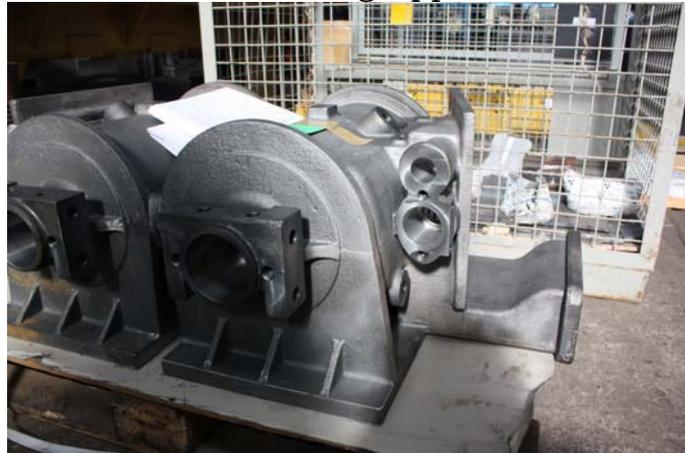
Dampfzylinder nach mechanischer Bearbeitung
