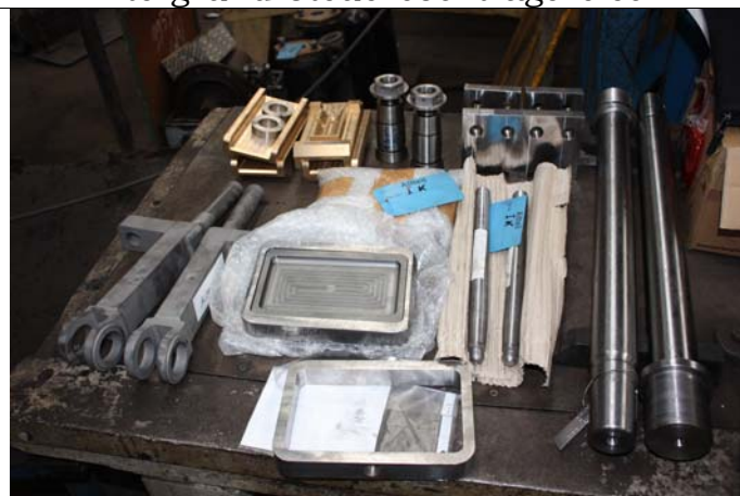
Schieberschubstangenverlängerung, Schieber/Schieberrahmen, Kolbenstangen
