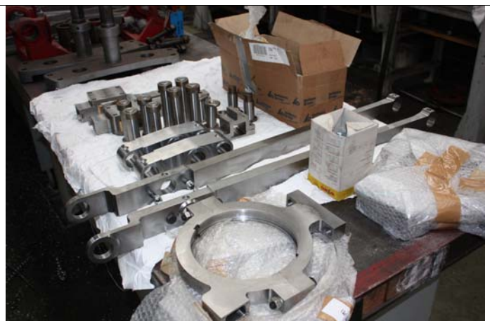
Schieberschubstange, weitere Steuerungsteile
