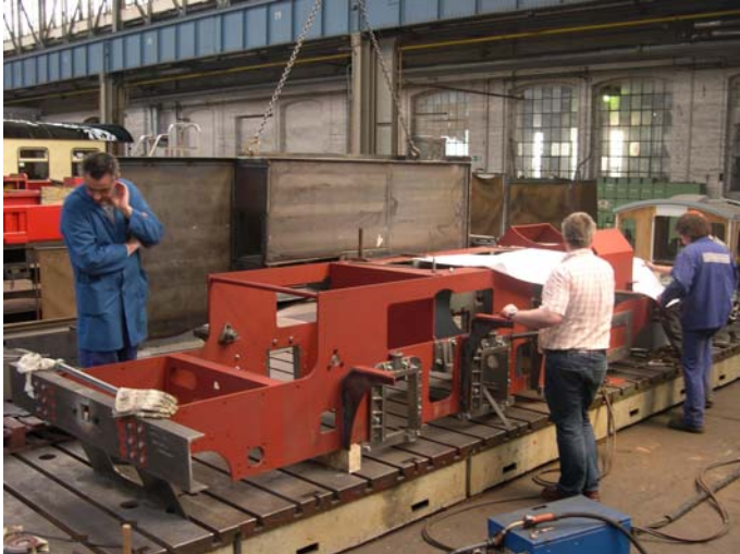
Probeweise Aufsetzen des linken seitlichen Wasserkastens auf dem Rahmen
